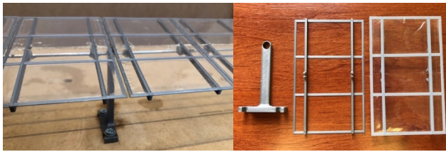
Figura 5. Ensayo de un “tracker” en el túnel aerodinámico.
